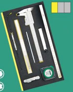
pied à coulisse; triple mètre; 2 pointes à tracer; réglet; jeu de jauges d'épaisseur; lime universelle ISO; jauge de filetage
